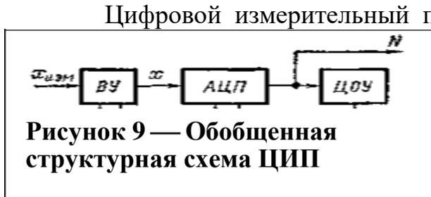
цифровой измерительный прибор (ЦИП) — это измерительный прибор, в котором входной сигнал преобразуется в дискретный выходной сигнал и представляется в цифровой форме. Под дискретным сигналом понимают прерывистый сигнал, в котором информация
