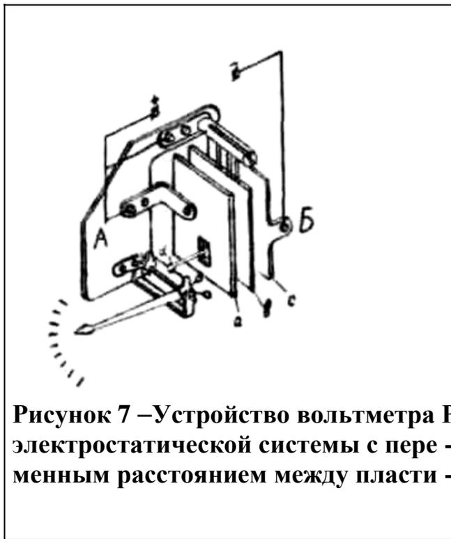
**Рисунок 7 – Устройство вольтметра**
