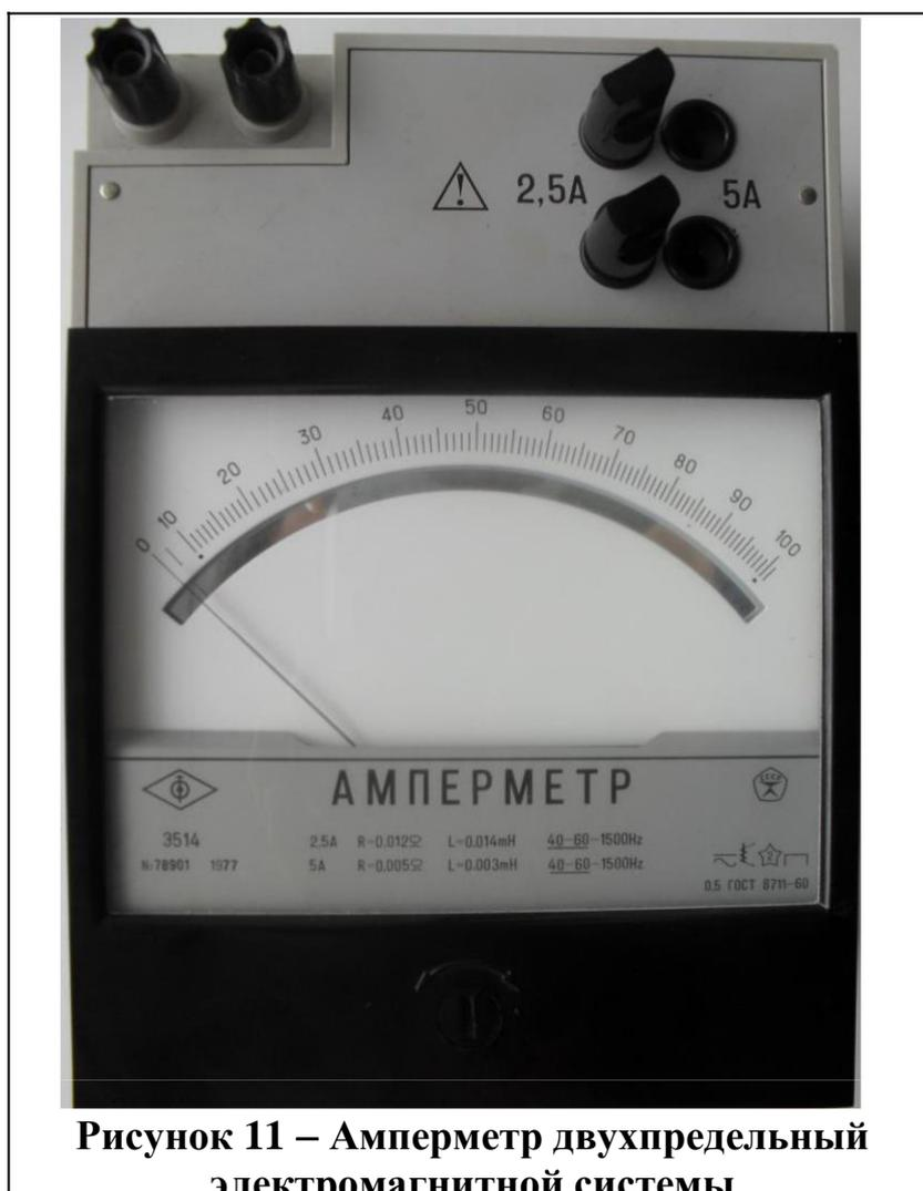
**Рисунок 11 – Амперметр двухпредельный электромагнитной системы**
