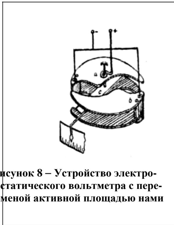
**Рисунок 8 – Устройство электро-статического вольтметра с пере-менной активной площадью нами**
