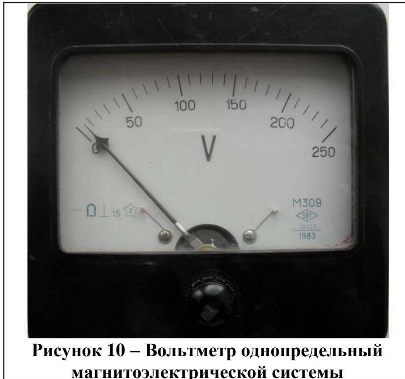
**Рисунок 10 – Вольтметр однопредельный магнитоэлектрической системы**
